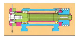
◀特に太く設計された鋸刃回転軸は長時間の連続負荷 に対しても充分な余裕をもったローラーベアリング とアンギュラーコンタクトベアリングにより支持さ れています。
