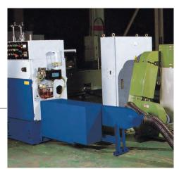
◀チップを吸引するサクション用ダクトです。 ダクトは鋸刃の走行に追従する二重スライド 方式により切断位置に関係なくチップを吸引 します。
