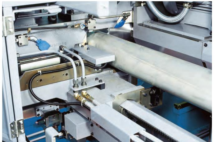
植物油をベースにしたミスト潤滑で、切削油は使用せず、ドライカットに近い切断方法により機械周辺の切削油の飛散、製品への付着はありません。
