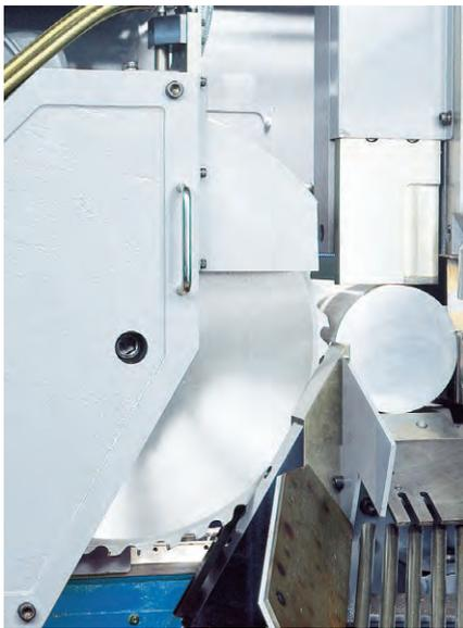
ソーヘッドは、精密加工されたギヤボックスに超精密ベアリングと高精度スピンドルが組み込まれ、長時間の連続高速運転に耐えます。
